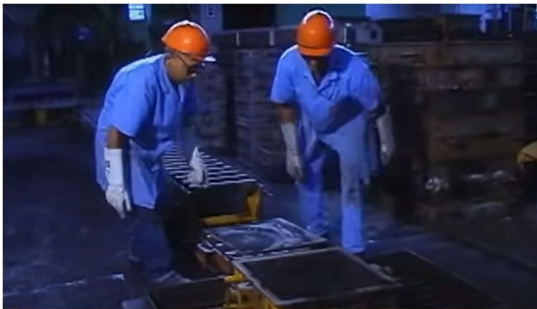
Figura 2-2: Carga manual de zaranda vibratoria
