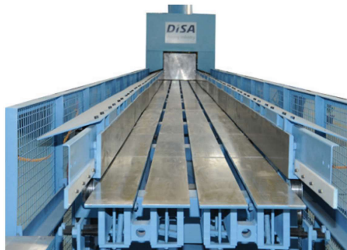
Figura 1-5: Avance del tren de motas continuo
