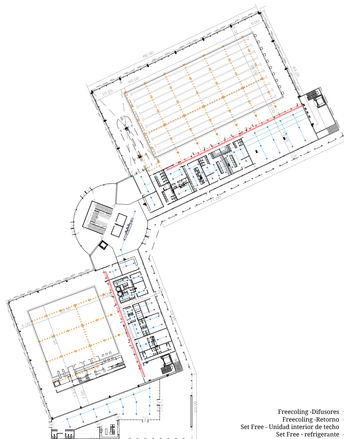
Instalación climatización - Planta baja. Esc. 1:750
