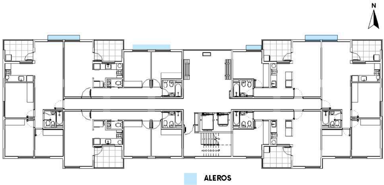
Figura 3.23 - Protecciones solares del edificio.
