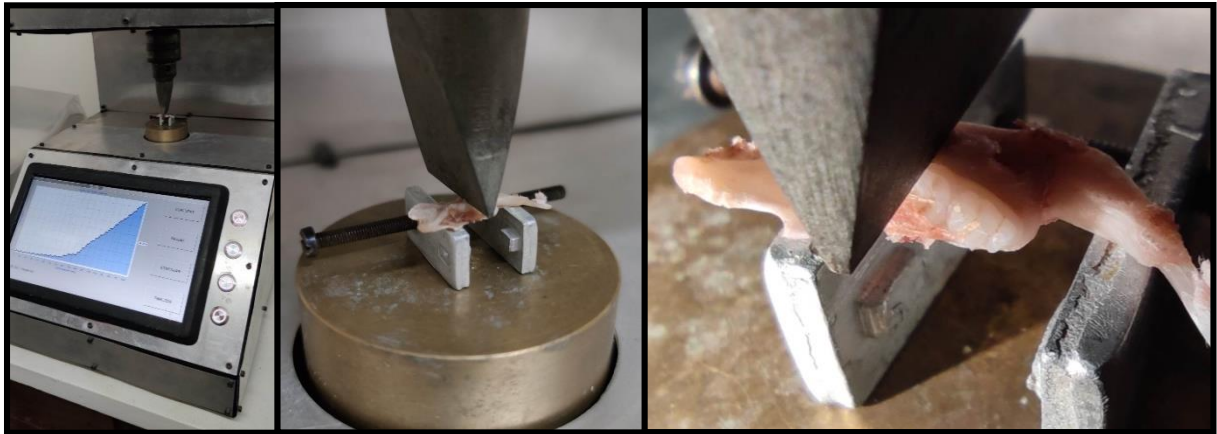
Figura 24. Ensayo de flexión a tres puntos para hemimandíbulas
