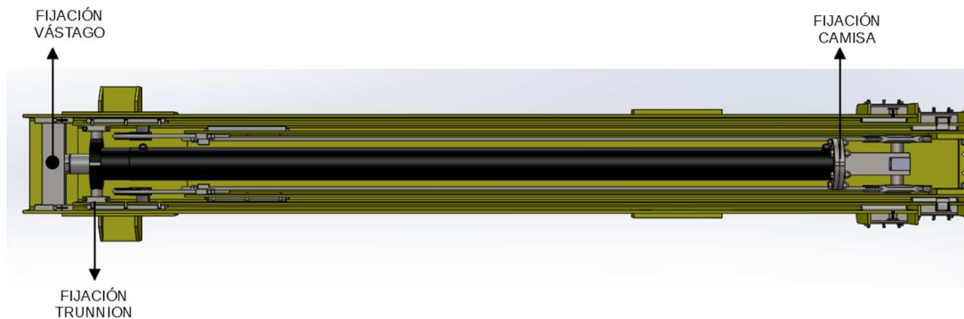
Figura 4-17: Puntos de fijación del cilindro
