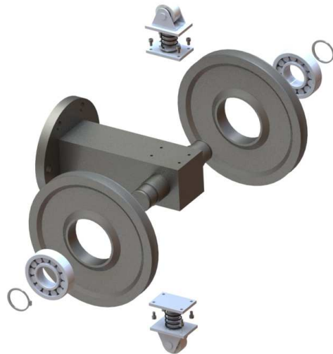
Figura 4-25: Vista explosionada del carro de poleas
