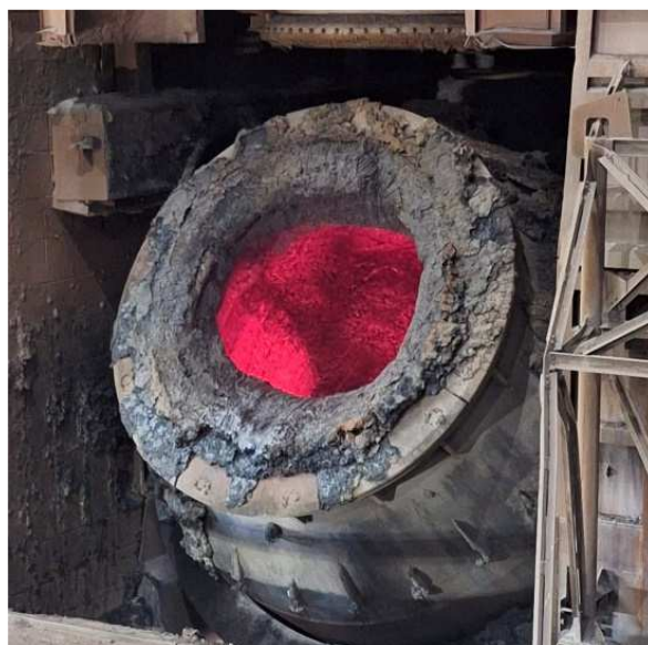
Figura 0-1: Boca del convertidor en operación con adherencias
