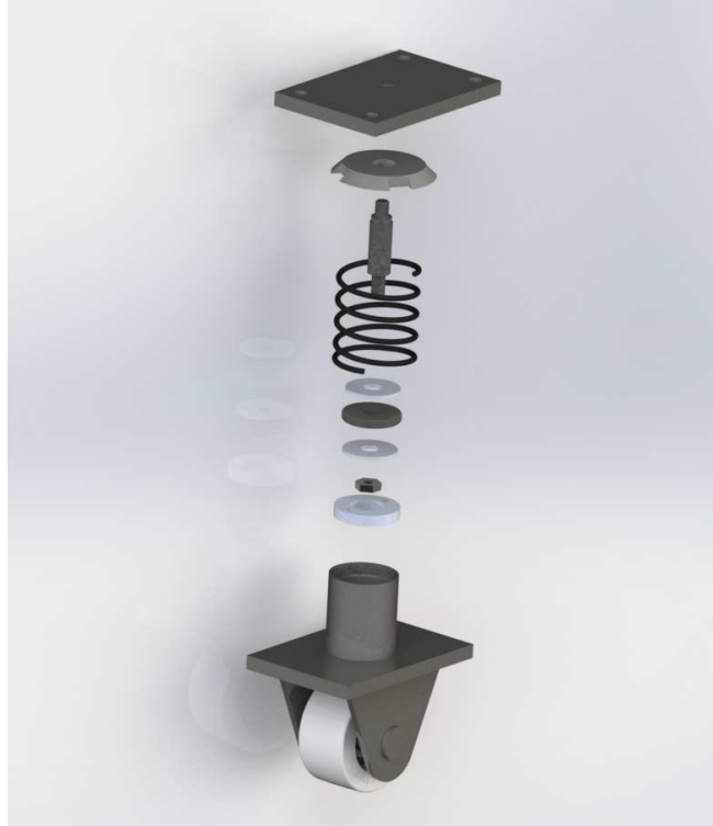
Figura 4-28: Vista explosionada sistema de guiado
