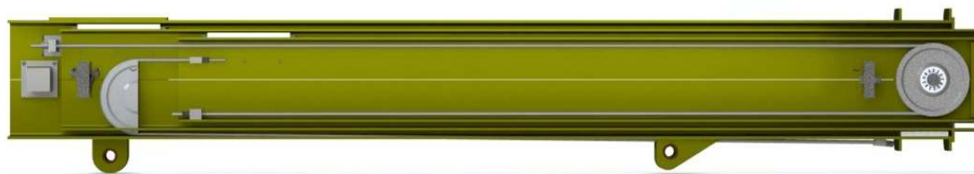
Figura 4-16: Transmisión por poleas y cables de acero
