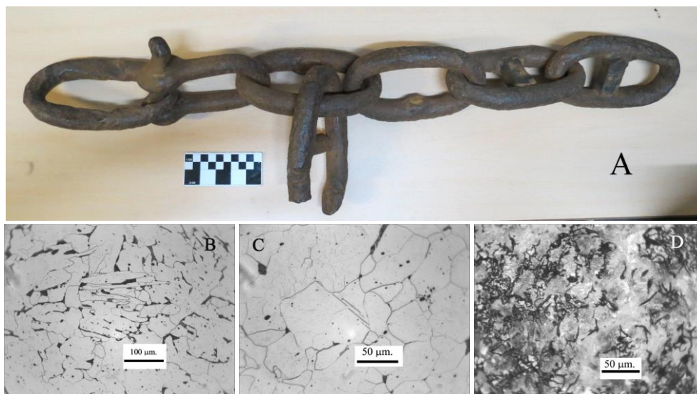
Figura 1. A) Tramo de cadena con grillete hallada por el Sr. Rodríguez hace décadas y entregada por intermedio de su hijo, Señor José María Rodríguez, al Director de Cultura. B) Microestructura constituida por ferrita y perlita con tamaño de grano irregular. Reactivo de ataque Nital 2. C) Bandas de Neumann en la estructura ferrítica. Reactivo de ataque Nital 2. D) Estructura de fundición gris del concreto analizado. Reactivo de ataque Nital 2.
