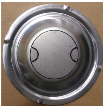
Figura 7.1: Muestra de Marciniak cortada por electroerosión de una probeta predeformada por estiramiento equibiaxial balanceado con punzón plano de 90 mm de diámetro
