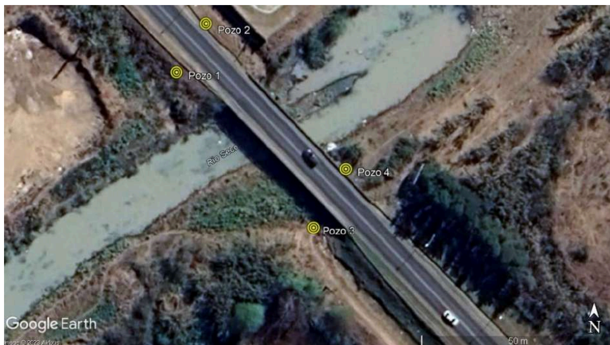
Figura 24 - Croquis de ubicación de las perforaciones. Fuente: Estudio de Suelos Puente sobre arroyo Seco (2023).
