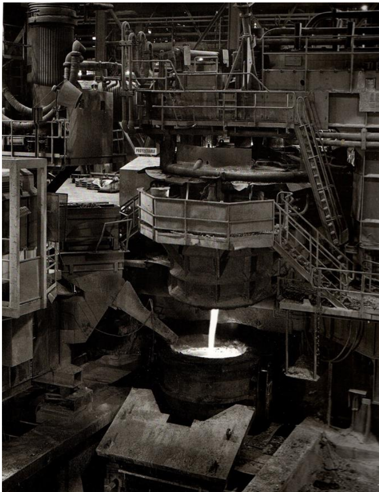
Colada de uno de los hornos de la acería. Fuente: Siderca, por Marcos Zimmermann.
