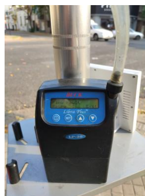
Referencia: Ambas imágenes corresponden a la toma de muestras y los equipos empleados para realizar la medición. La imagen de la izquierda muestra la central meteorológica junto al equipo impactador para determinación \text{PM}_{10}/\text{PM}_{2,5} y TSP. La imagen de la derecha muestra la bomba de alto caudal.
