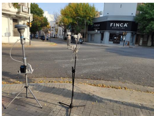
Referencia: Ambas imágenes corresponden a la toma de muestras y los equipos empleados para realizar la medición. La imagen de la izquierda muestra la central meteorológica junto al equipo impactador para determinación \text{PM}_{10}/\text{PM}_{2,5} y TSP. La imagen de la derecha muestra la bomba de alto caudal.
